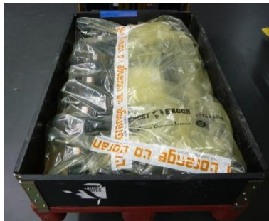
Bei Paletten und Gitterboxen VCI-Folie falzen und zukleben
