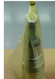
VCI-Folie mit Kabelbinder schließen
