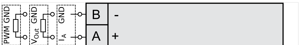
Fig. 86: Sortie du contrôleur analogique - deux fils
