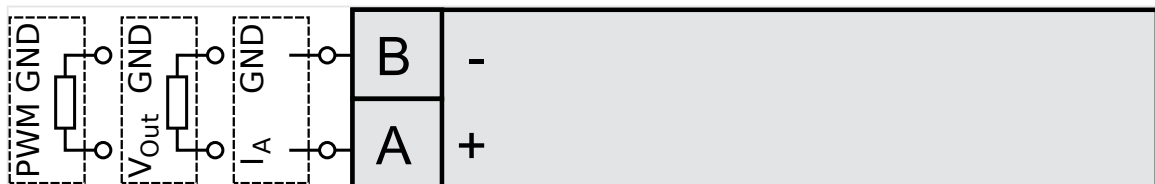
Fig. 73: Sortie du contrôleur analogique - deux fils
